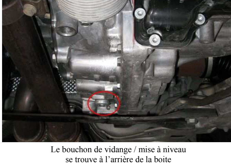
Le bouchon de vidange / mise à niveau se trouve à l'arrière de la boîte
